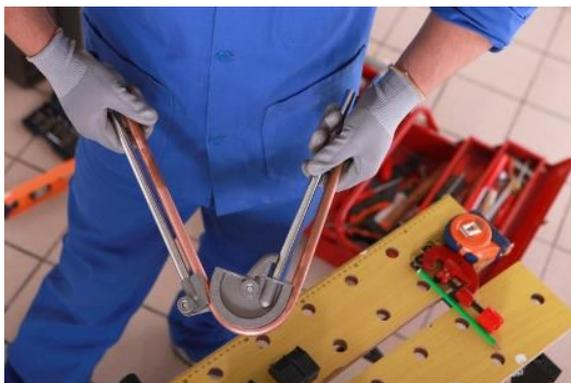
Abbildung 1 - Rohrbiegeapparat im Einsatz
